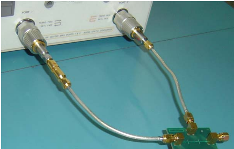
Figura 5-7: Arranjo de teste, equipamento de medição e a placa de testes.
