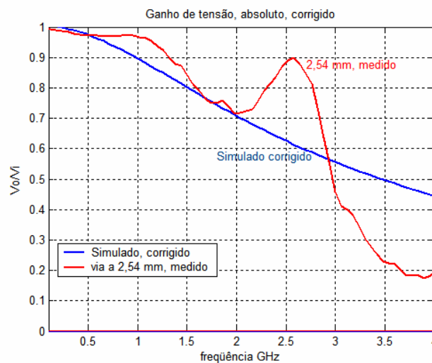
Figura 5-19: Ganho absoluto (medida do módulo de S21) para linha com via a 2.54 mm do centro interligando os planos, valores medidos e simulados corrigidos.
