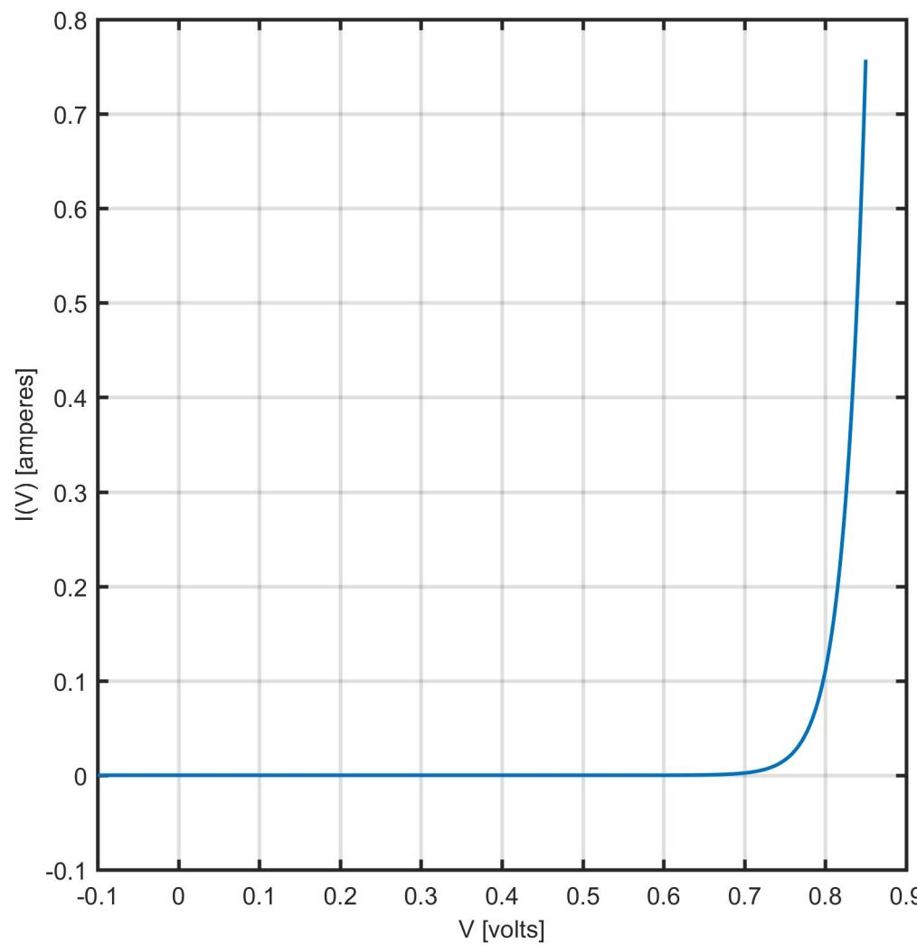
**Exercício 2)** Um diodo de junção PN de Si polarizado diretamente com corrente constante é utilizado como termômetro. Em  $T = 27^\circ \text{C}$  a tensão no diodo é de 700 mV.
