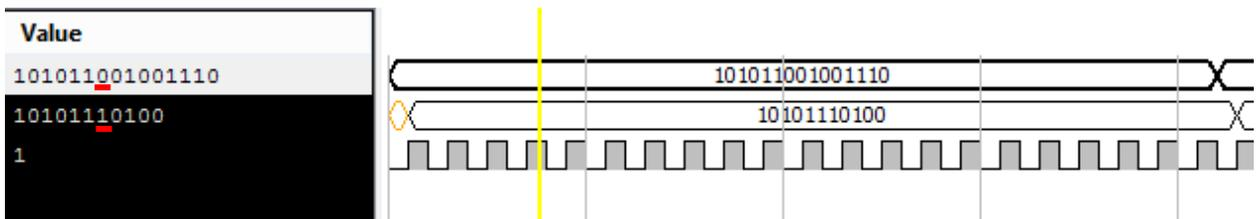
Figura 32 – Resultado decodificador C (15,11)
