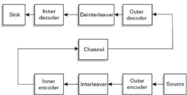
RS(204,188),  $t = 8$  (encurtado de RS(255,239) sobre GF( $2^8$ )) concatenado com CC(2,1,7),  $d_{\text{free}} = 10$
