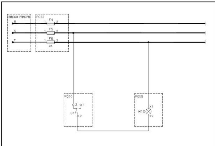
Fig. 1 – interruptor simples em série com uma lâmpada
