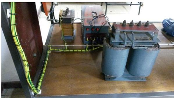
(Figura 12 – Fiação não segue padrões de cores definidos na NBR5410)
