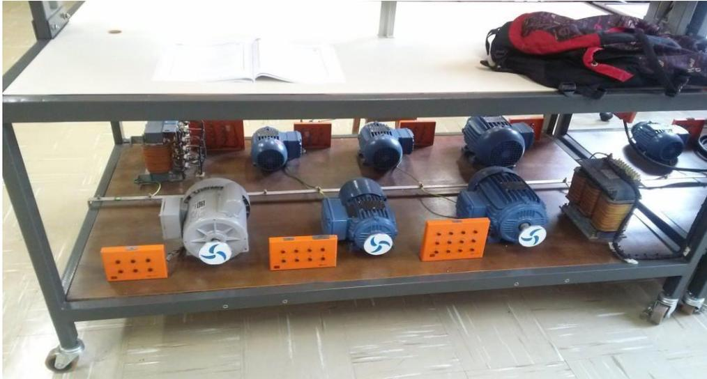
Figura 13 – Motores sem grade de proteção.
