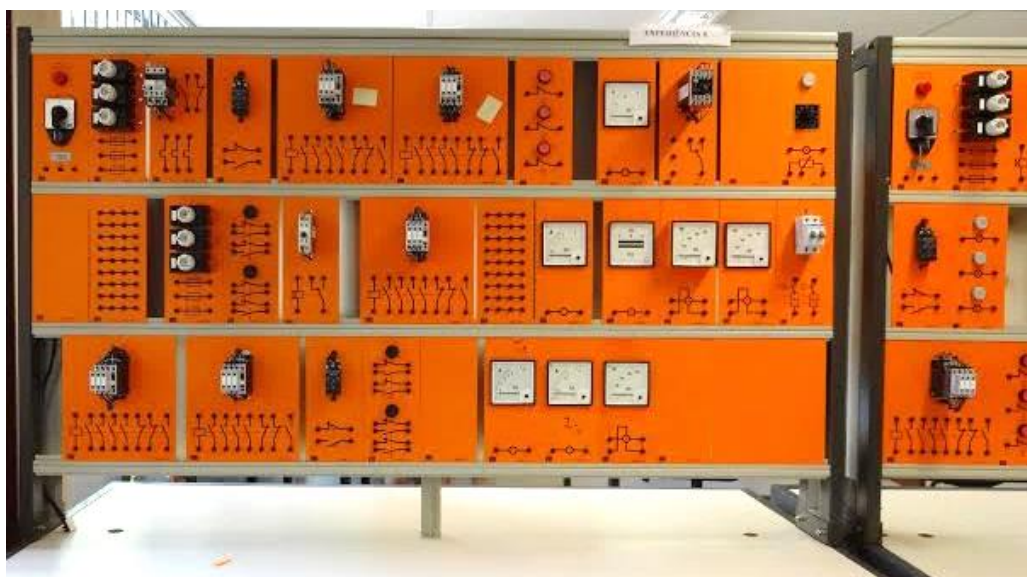
Figura 14 - Bancada sem botão de emergência. Fonte: As autoras (2014)
