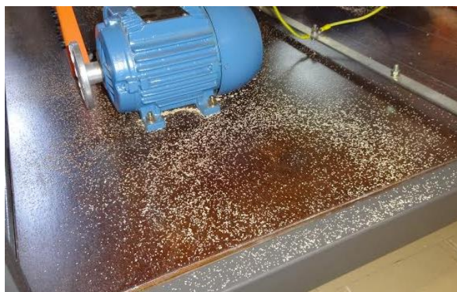
Figura 20 - Parte superior da bancada com cupins. Fonte: As autoras (2014)
