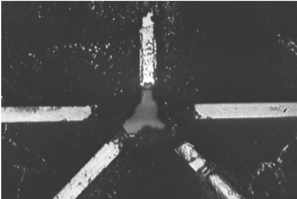
Figure 3.10 : Photo au microscope optique d'une micro bobine après essai destructif avec un courant supérieur à 3800 A.
