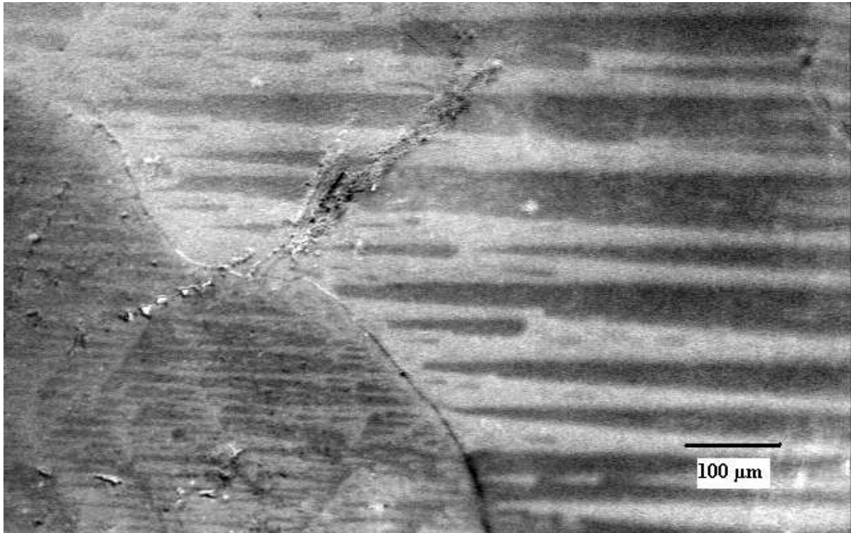
Figure 5.9 : Image Kerr longitudinale statique d'un échantillon de FeSi à la rémanence. Un joint de grain peut être clairement observé, qui sépare une région de grands domaines (à droite) d'une autre avec des petits domaines (gauche).
