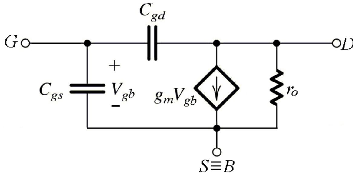
$C_{gs}$  : Capacitância entre Gate e Fonte/Substrato
