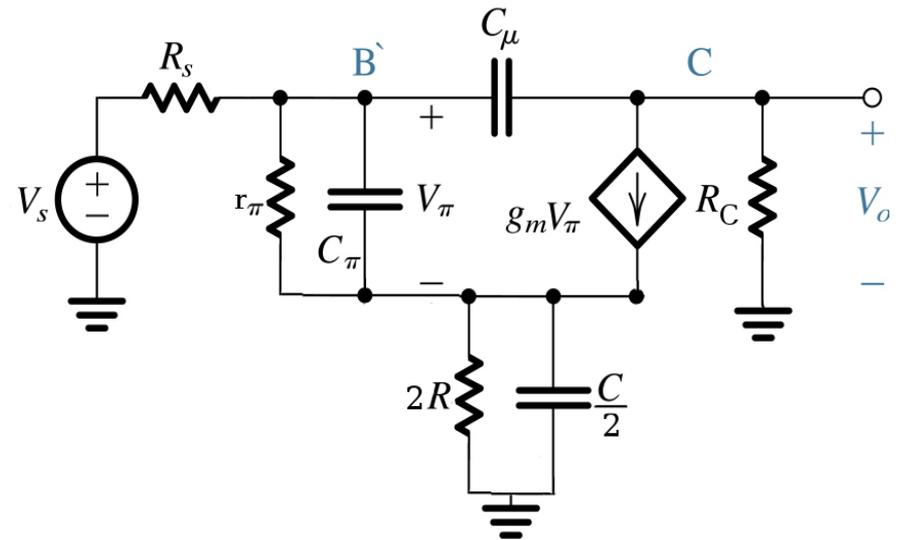
O RC da fonte de corrente gera um zero na função de transferência
