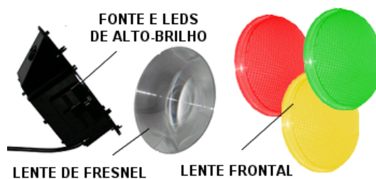
Fig. 4.b Módulo focal a LED para semáforos, Modelo Série 433 Dialight.
