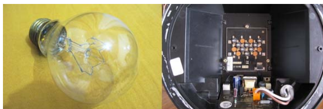
Fig. 3. Comparação de uma lâmpada IFR convencional (100W) e o módulo focal de LED (10W) adotado no projeto.
