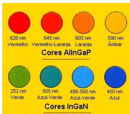
Fig. 2. Comprimentos de onda e tecnologia empregada em diodos emissores de luz (LED) [6]
