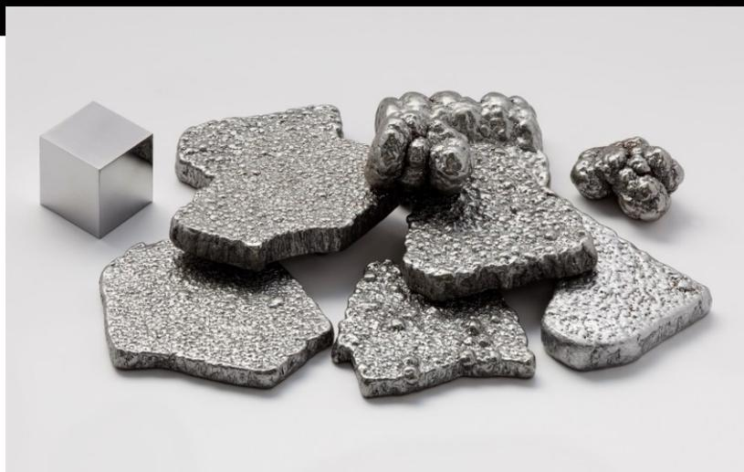
Ferro nodular produzido por fornos primitivos e amostra de  $1 \text{ cm}^3$  de ferro 6N de alta pureza (99,9999%)
