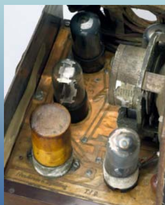
Rádio construído em 1946 por Paul Eisler, usando circuito impresso
