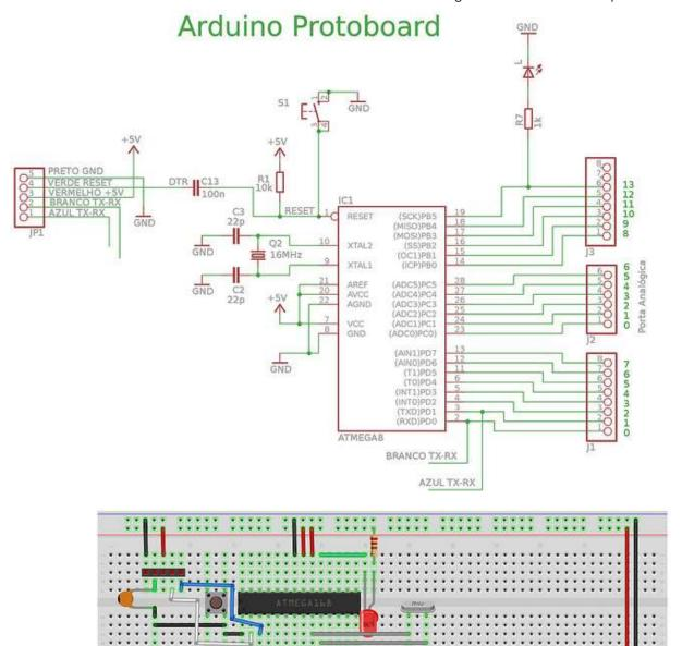
Tarefa: Projetar uma placa de circuito impresso com o menor tamanho possível (máximo 8 cm X 10 cm), implementando o *circuito mínimo* do ATMEGA8 mostrado. A alimentação de 5V deve vir de uma fonte externa, ligada à placa por um conector tipo "barril":
