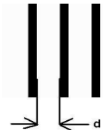
Figura 2 - Isolação entre trilhas
