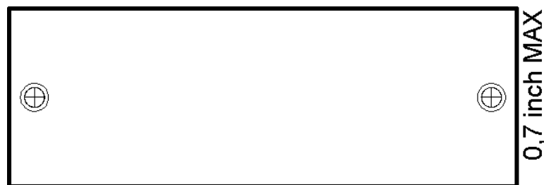
Figura 21: Dimensões máximas da placa de circuito impresso.
