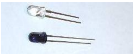
Figura 23: Aspecto do LED (invólucro azulado) e do Foto-Diodo.
