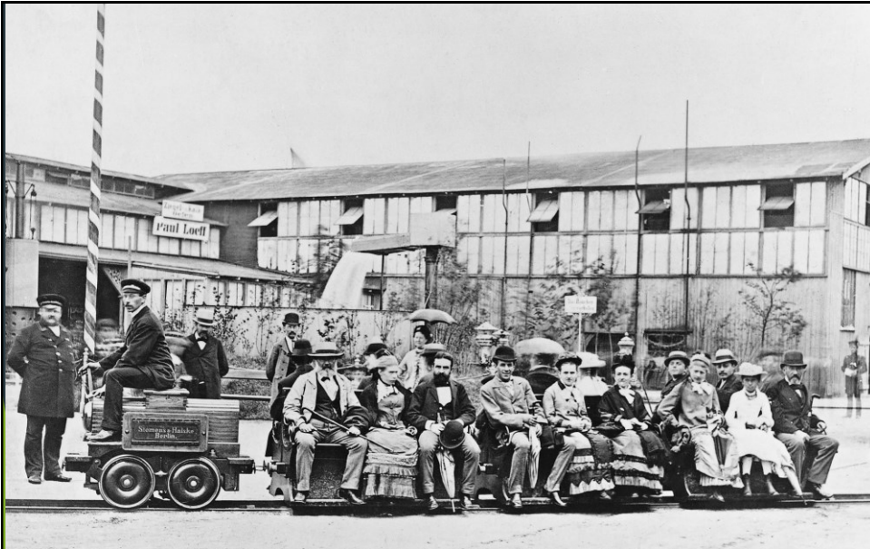
1879 - Elektrolokomotive - Werner von Siemens 300 m, 150 V DC, Motor 2,2 kW, max. 7km/h
