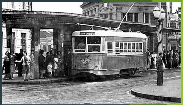
Algumas fotos mostram bondes da CCTC pós-1945 remodelados, com duas janelas frontais e chassi totalmente diferente do modelo Birney.
