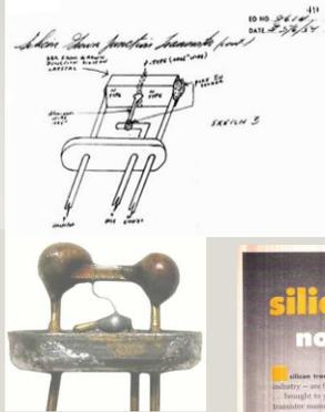
Instruções de montagem do transistor de silício da TI
