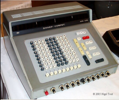
Calculadora eletrônica Sharp CS-10A, de 1964, ainda não possuía um microprocessador e o circuito eletrônico usava 530 transistores de germânio e 2300 diodos. Peso: 25 kg Preço: 535.000 ¥ (aprox. 1450 US$, na época)
