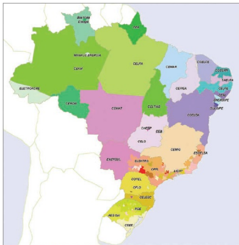
Figura : Áreas de abrangência das concessionárias de distribuição de energia elétrica (Fonte ANEEL, 2005).
