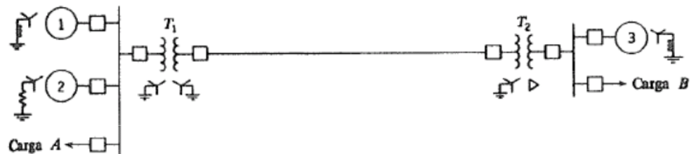
Fig. 1: Diagrama unifilar representando um Sistema Elétrico trifásico
