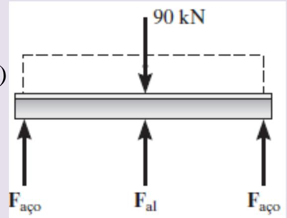
A posição final da parte superior de cada poste é igual ao deslocamento causado pelo aumento da temperatura e a força de compressão axial interna.
