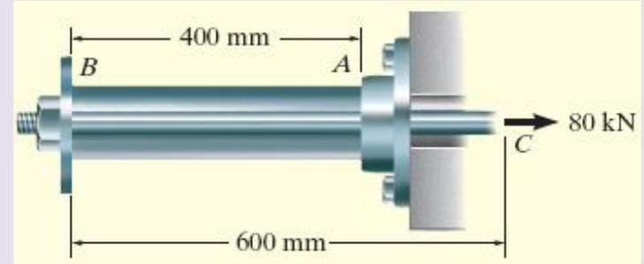
O deslocamento da extremidade  $B$  em relação à *extremidade fixa*  $A$  é
