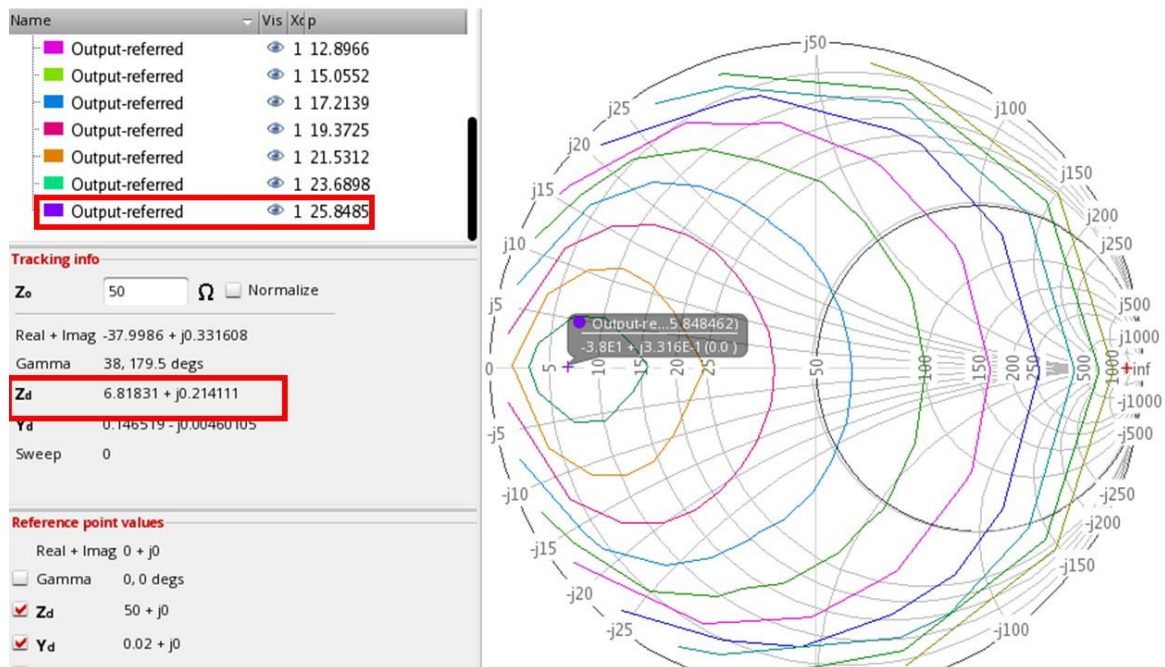
FIGURA 13 - CARTA DE SMITH COM RESULTADO DA SIMULAÇÃO LOADPULL
