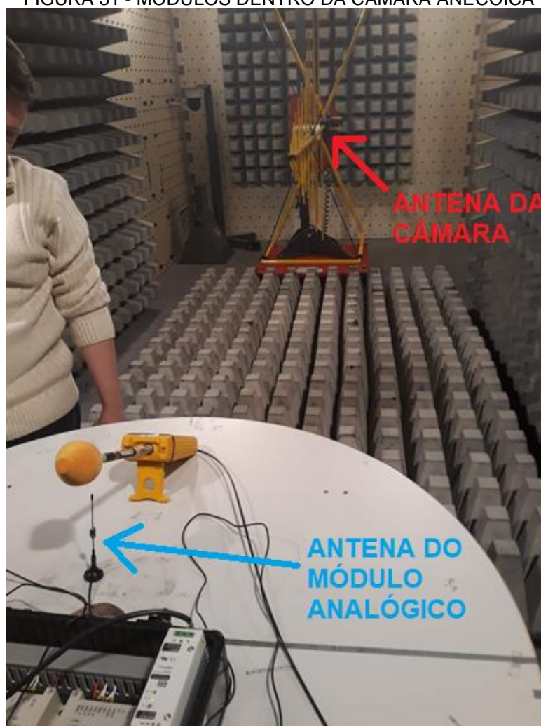
FIGURA 31 - MÓDULOS DENTRO DA CÂMARA ANECÓICA
