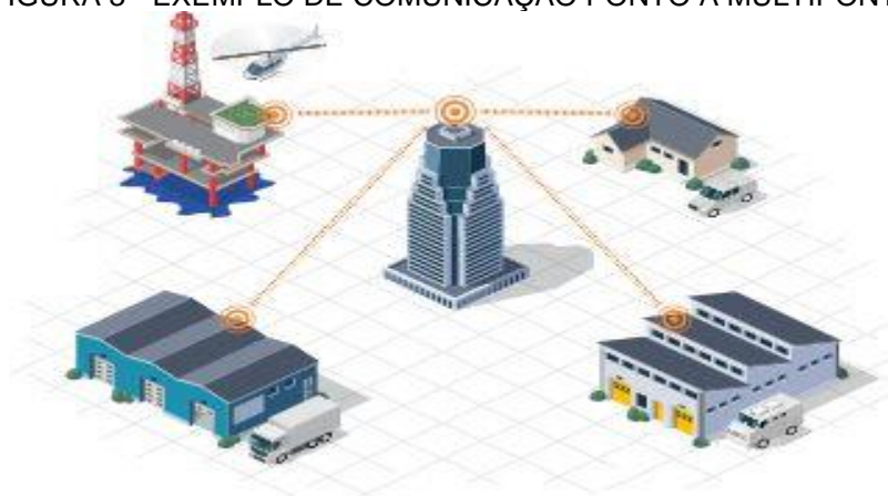
FIGURA 3 - EXEMPLO DE COMUNICAÇÃO PONTO A MULTIPONTO
