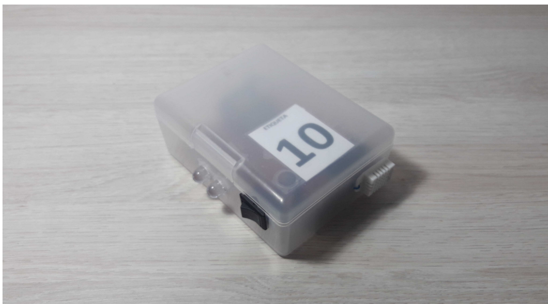
Figura 33 – Gabinete plástico para o suporte do sistema eletrônico projetado.
