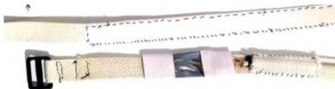
Figura 21 – Cinta torácica onde foi anexada o invólucro de ar que contém o sensor de pressão BMP180.
