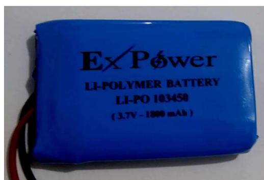
Figura 35 - Imagem da bateria lítio-polímero de 1800mAh usada para suportar o processamento do ESP com a transmissão de dados.
