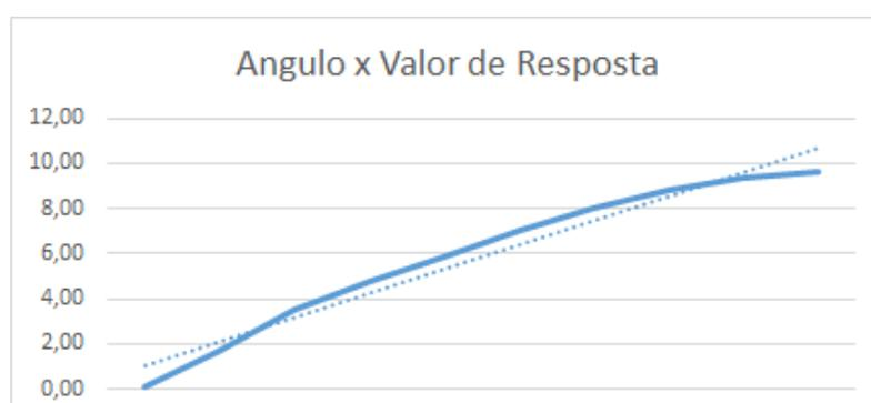
Figura 30 - Curva de resposta das intensidades atribuídas pelo sensor MPU6050 em resposta a um ângulo isolado.
