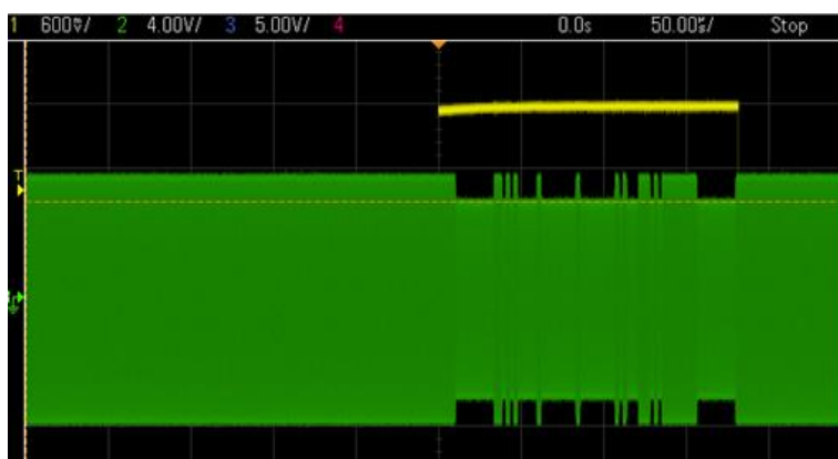
Figura 1 - Exemplo de sinal NFC, adquirido com um osciloscópio. Fonte: O autor (2019)
