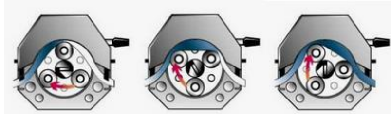
Figura 3: Funcionamento de uma bomba peristáltica.
