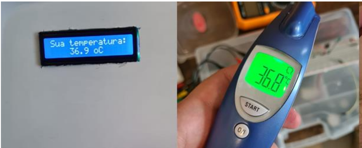
Figura 37: Comparação medição de temperatura do protótipo e do termômetro clínico.
