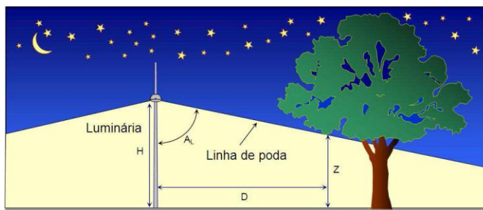
Figura 29 – Projeção da desobstrução longitudinal
