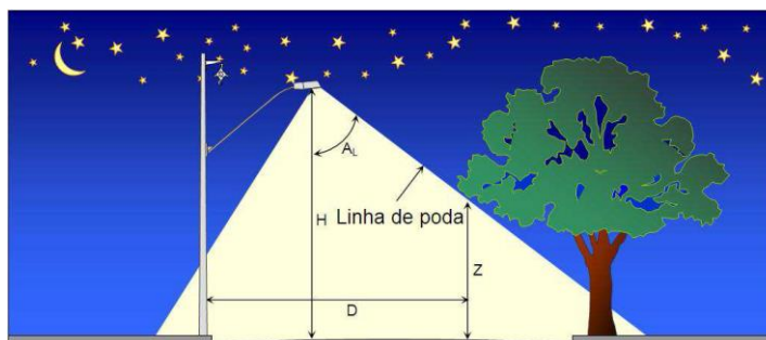
Figura 30 – Projeção da desobstrução lateral
