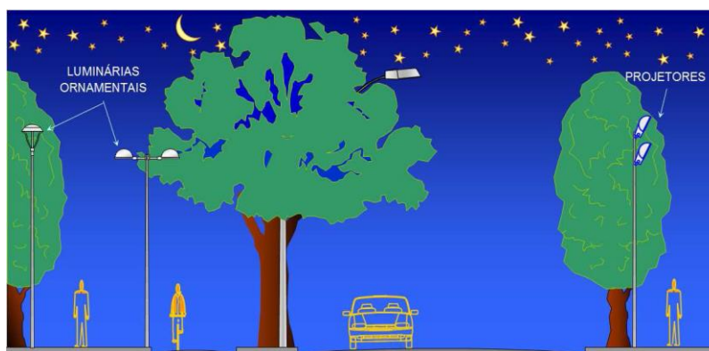
Figura 28 - Propostas para projetos específicos de iluminação pública para passeios em áreas com intensa arborização.
