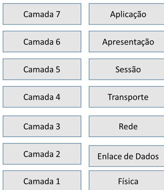
FIGURA 1 – Padrão OSI de sete camadas (ISO 7498).
