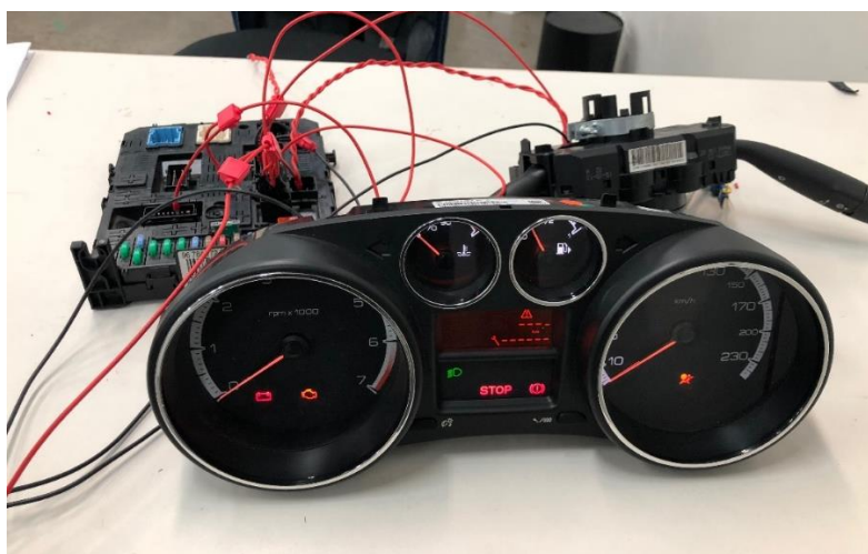
FIGURA 23 – Primeiro teste de funcionamento do painel de instrumentos e BSI
