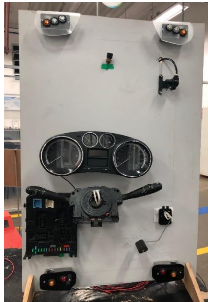
FIGURA 24 – Fixação de componentes na chapa de MDF
