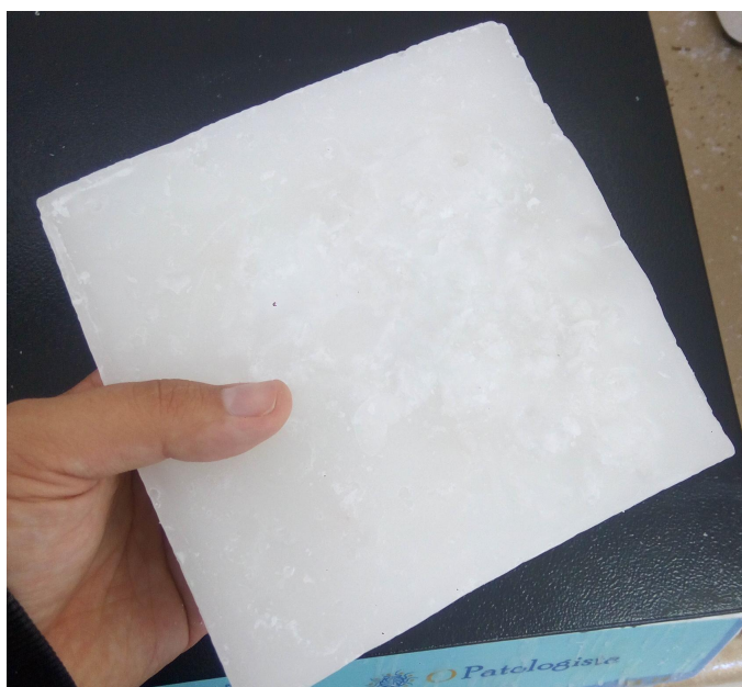
Figura 8 – Placa de parafina pronta com as partículas quirais dispostas em seu interior. Fonte: o autor.
