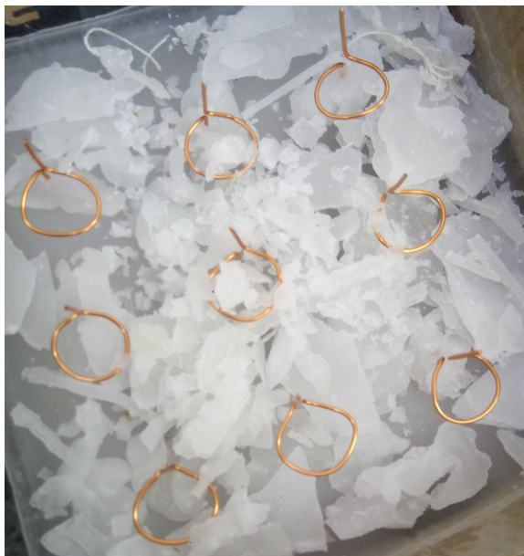
Figura 7 – Montagem do metamaterial do primeiro experimento com as partículas na disposição de Alitalo et al.[7]. Fonte: o autor.
