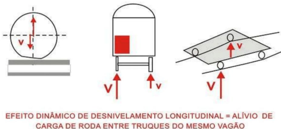
Figura 2.5: Efeito Dinâmico do Desnivelamento Longitudinal
