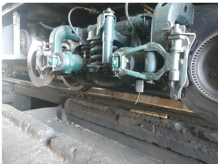
Figura 3.2: Módulo secundário fixado na barra de carga do lado direito do trem
