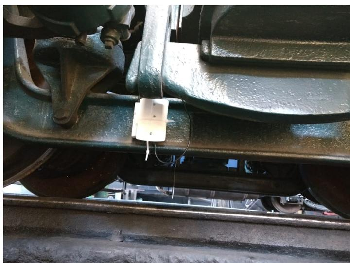
Figura 3.3: Módulo secundário fixado na barra de carga lado esquerdo do trem
