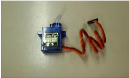
Figura 34 – Alavanca e conexões para o servo motor.
