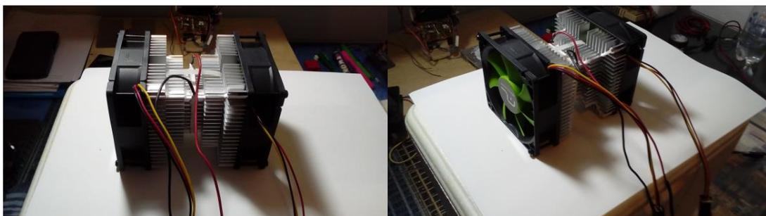
Figura 46 – Montagem dos dissipadores e ventoinhas à Peltier.
