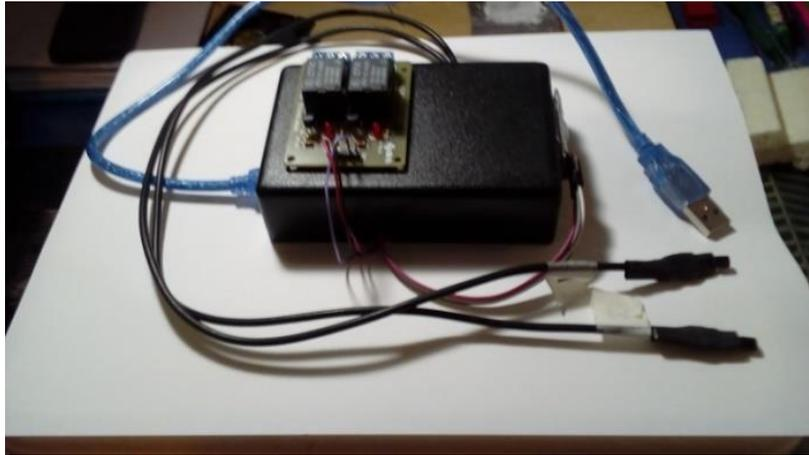
Figura 47 – Montagem do sistema de medição de temperatura.
