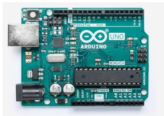
Figura 44 – Placa *Arduino* UNO.
