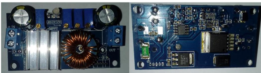
Figura 24 – Módulo Controlador MPPT 5A *Step Down*.
