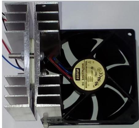
Figura 21 – Detalhe do ventilador acoplado ao conjunto célula de Peltier e dissipadores.
