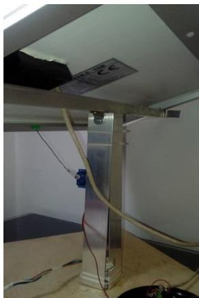
Figura 35 – Visão geral do mecanismo robótico de alinhamento à fonte de luz.
