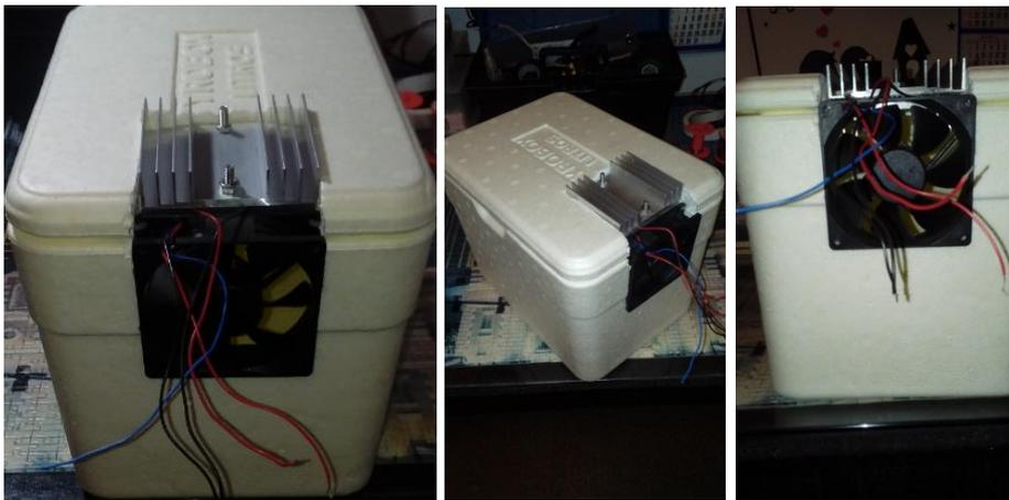
Figura 22 – Montagem do conjunto Peltier + dissipador em ambiente controlado.
