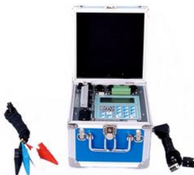
FIGURA 22 - ANALISADOR DE ENERGIA MARH-21
