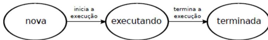
Figura 2.7: Diagrama de estados de um sistema monotarefa.
