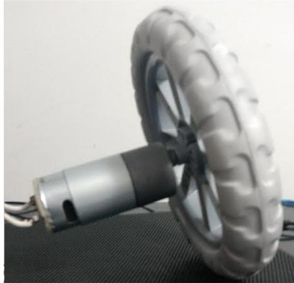
Figura 3.3: Motor acoplado a roda.
