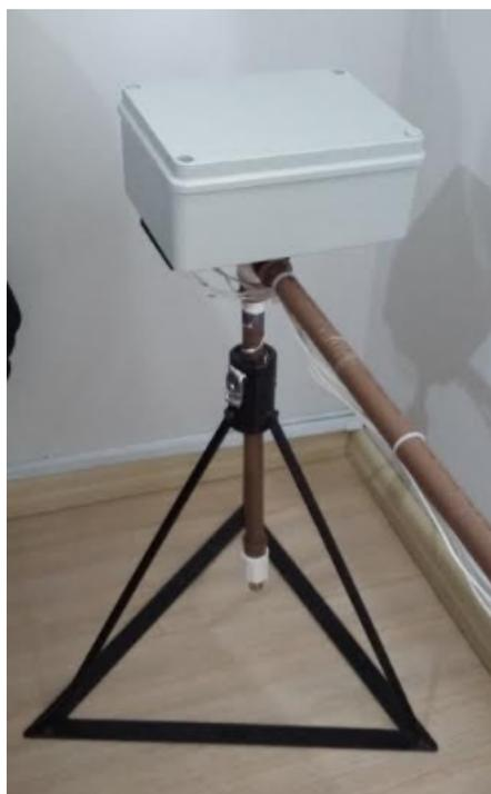
Figura 4.3: Caixa de montagem eletrônica do protótipo na base fixa.
