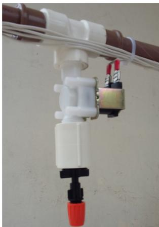
Figura 3.8: Válvula solenóide e bico aspersor.
