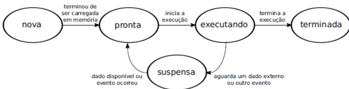
Figura 2.8: Diagrama de estados de um sistema multitarefa.
