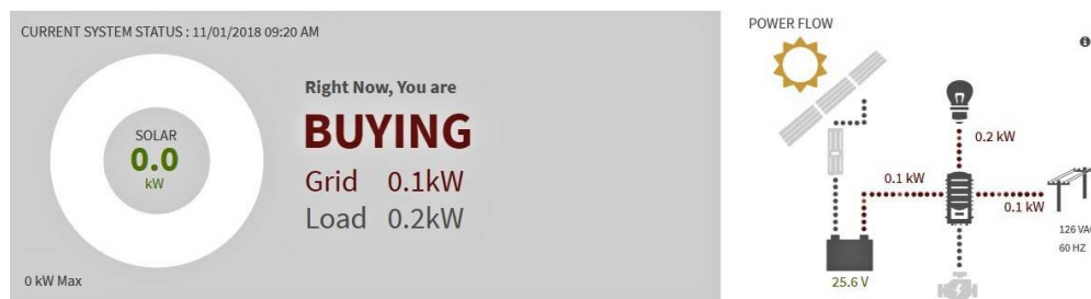
Figura 35 – Fluxo de potência para a carga visto pelo Optics RE
