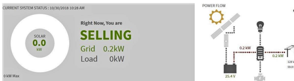
Figura 33 – Sistema vendendo energia para a rede visto pelo Optics RE
