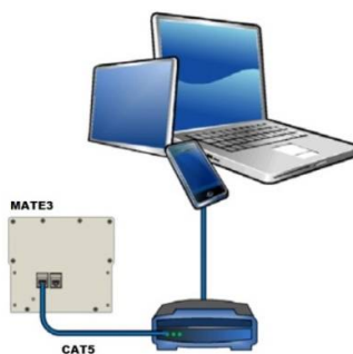
Figura 26 – Conexão do MATE3 à rede de Internet
