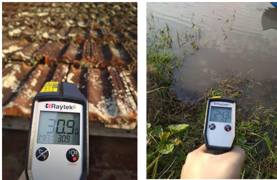
Figura 19 - Medição de Temperatura para telhado e lago, através de um termômetro infravermelho
