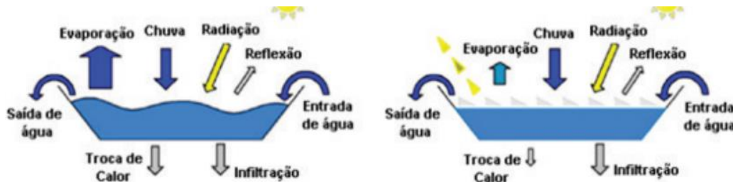
Figura 11 - Comparação com a instalação de um sistema flutuante na evaporação de um reservatório
