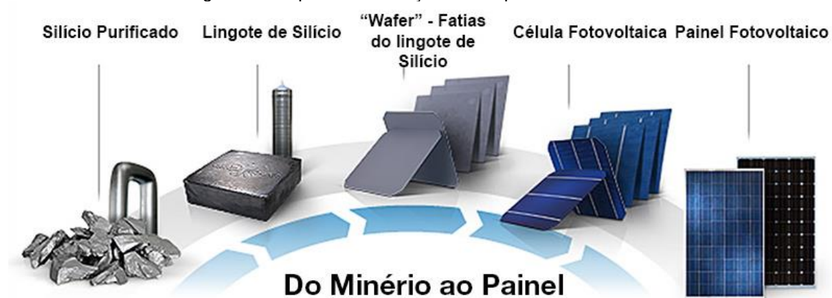
Figura 3 - Etapas da fabricação de um painel fotovoltaico.
