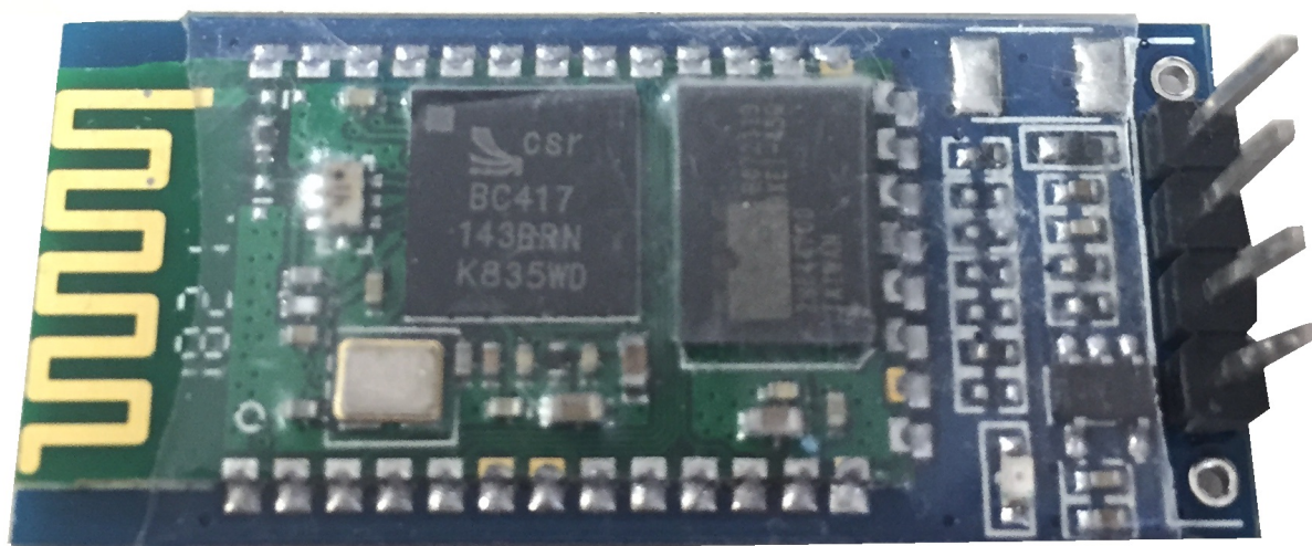
FIGURA 3.2 – Módulo bluetooth HC-06
