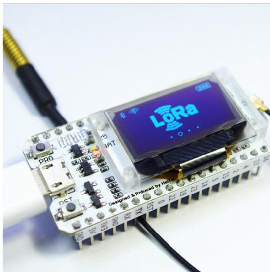
Figura 2.4: ESP32 integrado com rede LoRa
