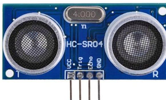
Figura 3.8: Sensor ultrassônico HC-SR04
