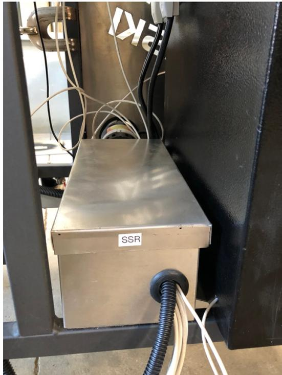
Figura 45 - Invólucro de tela com tampa para os SSRs
