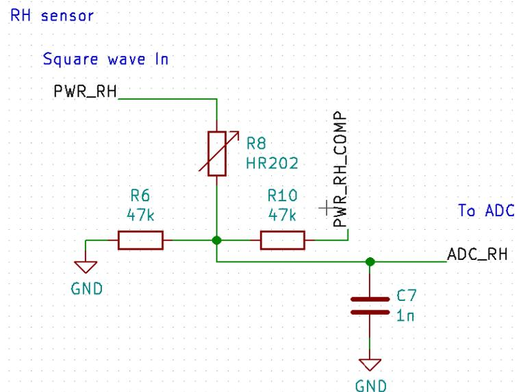
Figura 4.11: Circuito de condicionamento para o HR202. Fonte: O Autor(2018)
