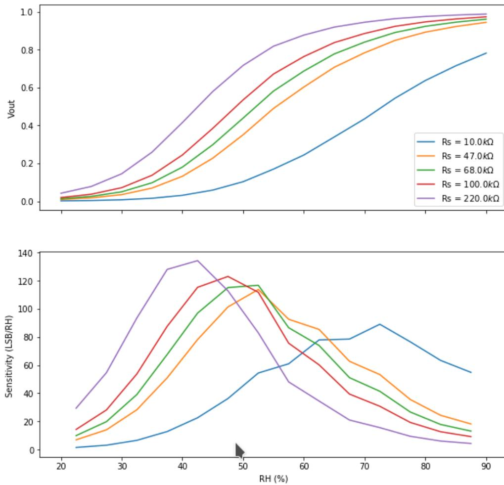
Figura 4.13: Simulações do sensor HR202. Fonte: O Autor(2018)
