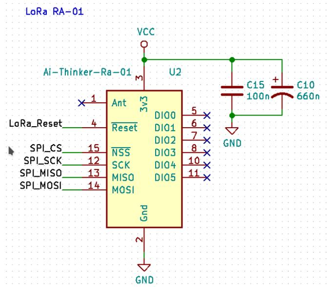
Figura 4.16: Esquemático do módulo LoRa. Fonte: O Autor(2018)
