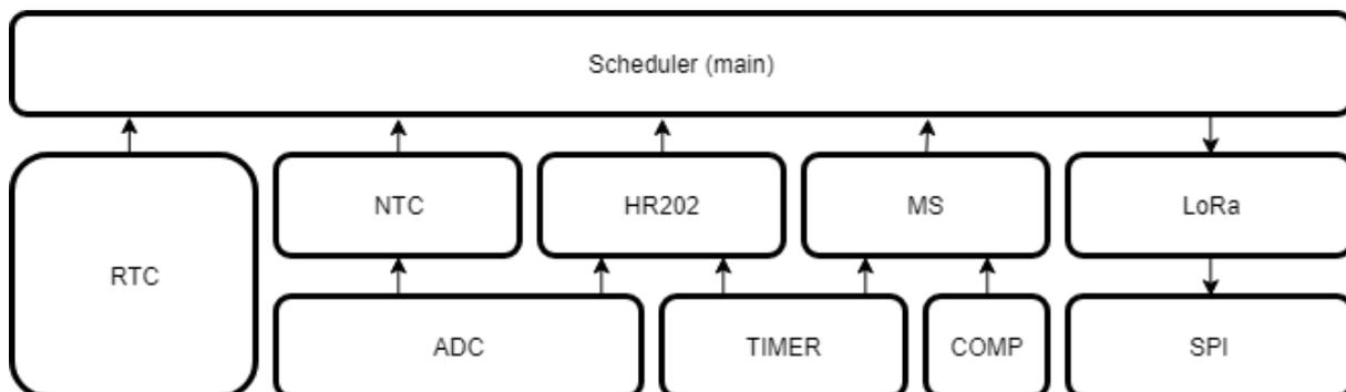
Figura 4.21: Diagrama da interação entre os módulos. Fonte: O Autor (2018)
