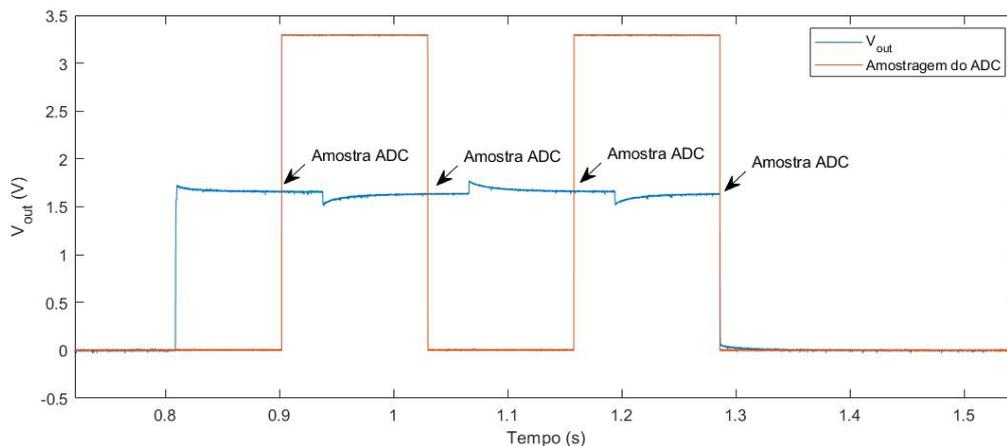
Figura 5.6: Tensão de saída na aquisição da umidade relativa do ar. Fonte: O Autor (2018)
