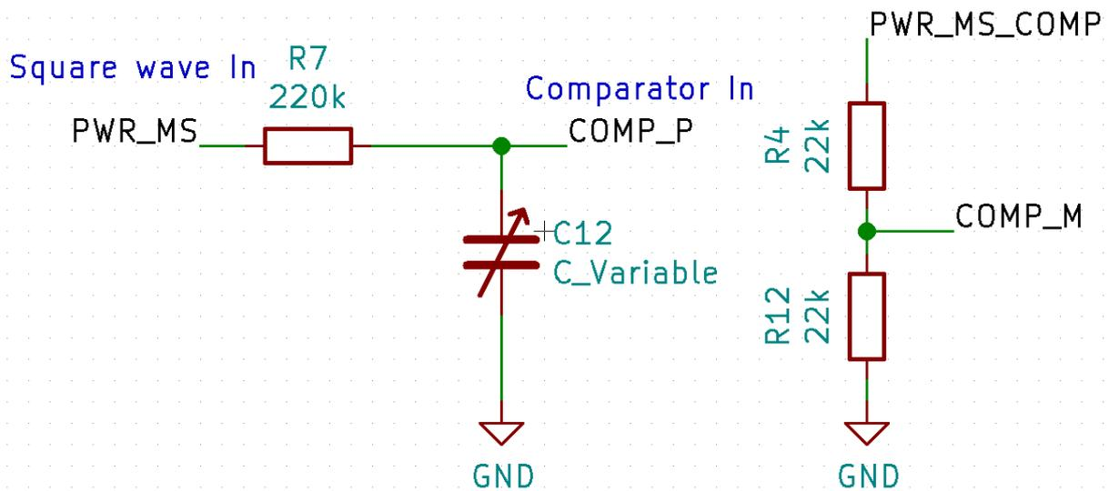
Figura 4.7: Circuito para aquisição do sinal do sensor de umidade do solo. Fonte: O Autor (2018)
