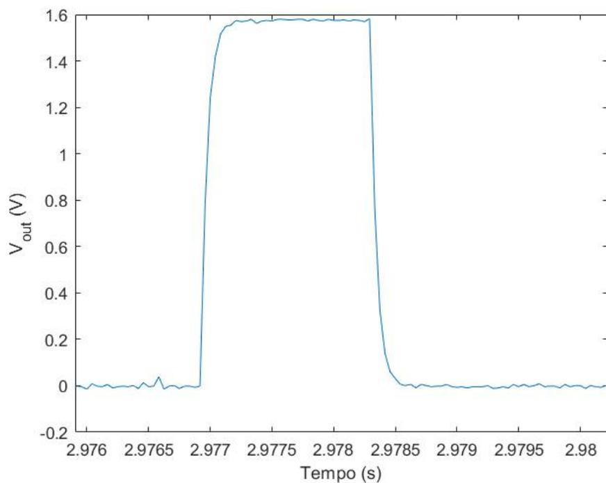
Figura 5.3: Tensão de saída na aquisição da temperatura. Fonte: O Autor (2018)
