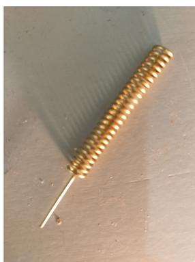
Figura 4.20: Antena do módulo LoRa. Fonte: O Autor (2018)
