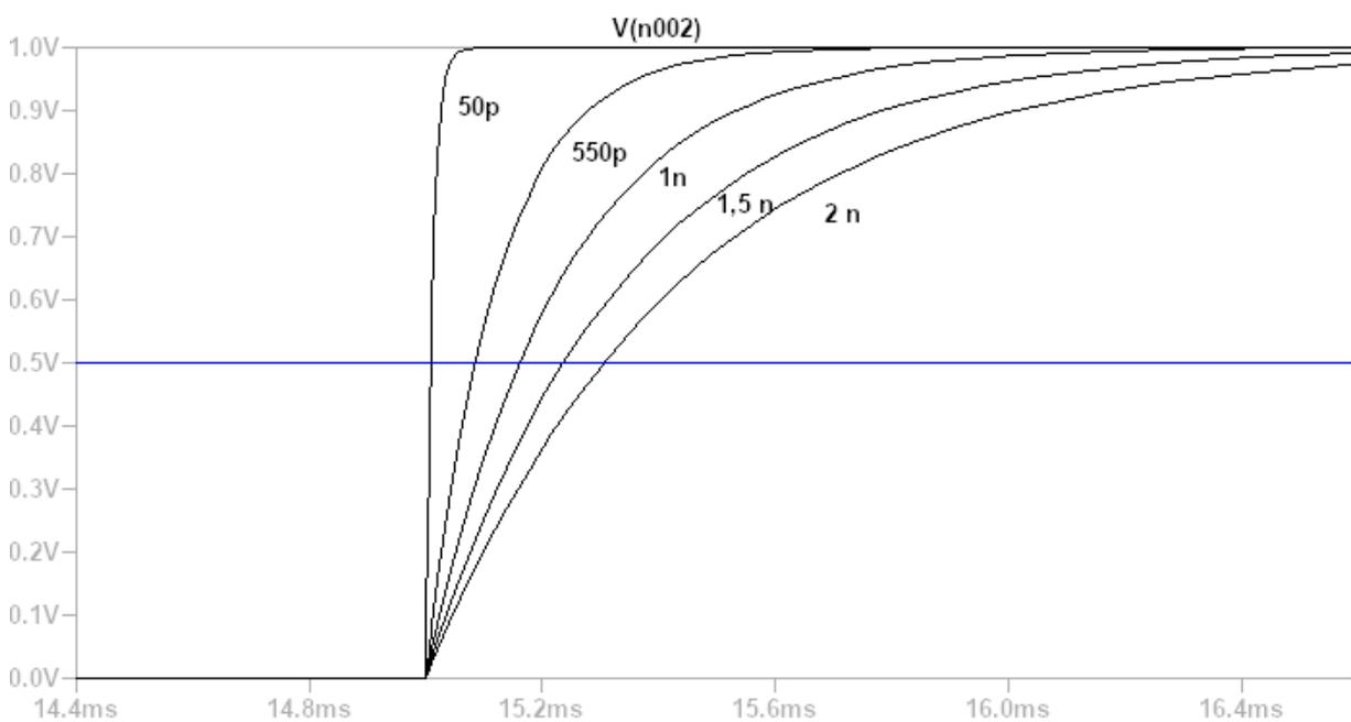
Figura 4.9: Resultado da simulação do sinal do sensor de umidade do solo. Fonte: O Autor (2018)
