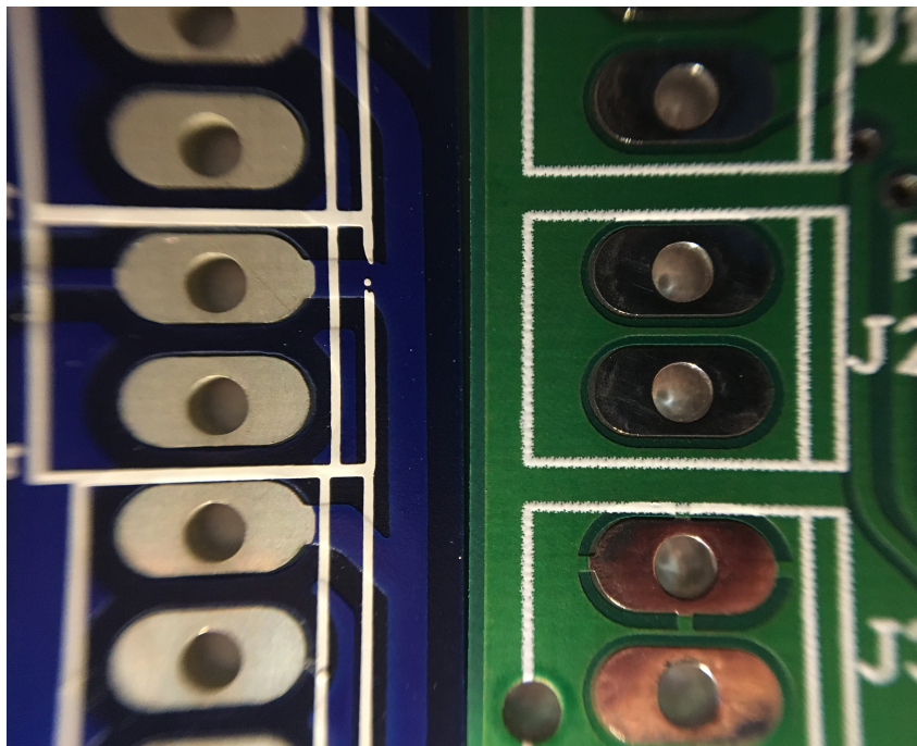
Figura 50 – Comparação do acabamento dos terminais de solda
