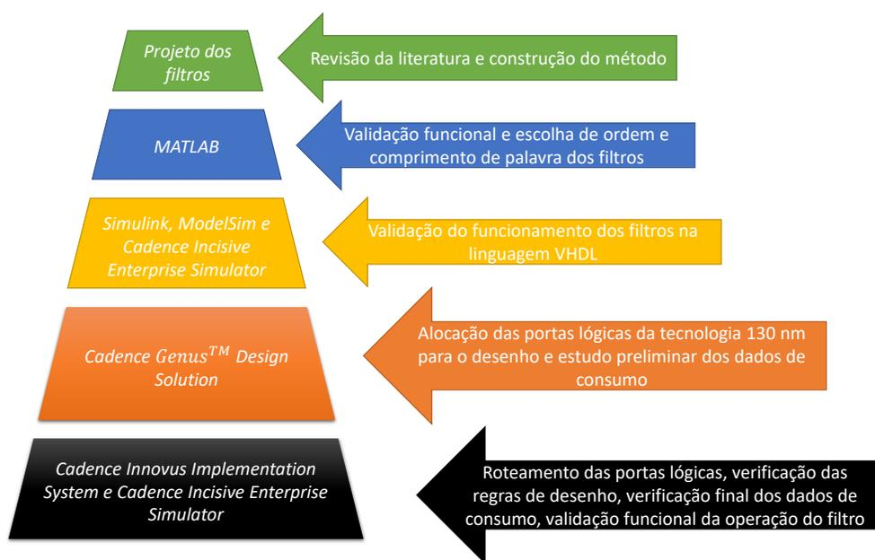
Figura 7: Diagrama representando as atribuições de cada simulador.
