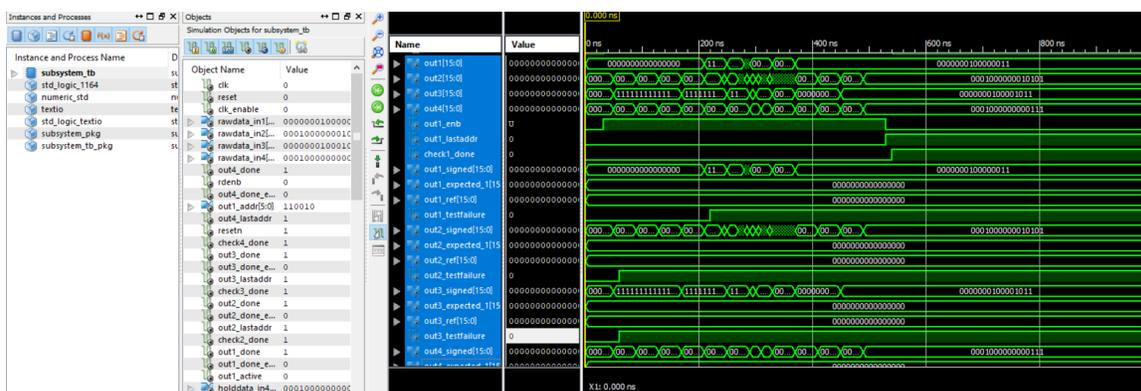
Figura 9: Forma de simulação implementada através do simulador *ModelSim* para o teste do filtro digital.
