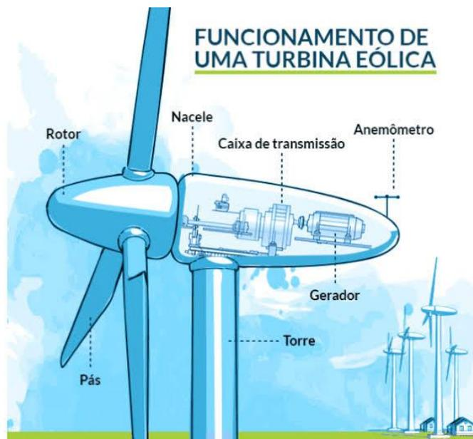
Fonte: Viva Decora, Energia eólica: componentes de um aerogerador (ilustração: A2ad)
