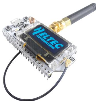
Figura 1 – Placa de desenvolvimento Wifi Lora 32 v2 - Heltec
