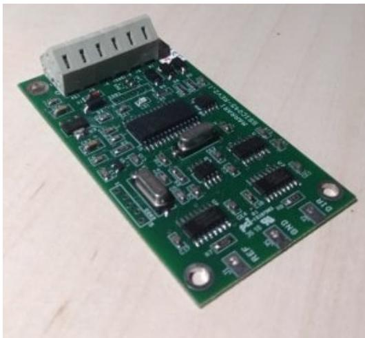
Figura 3 – Placa sensora de umidade SSIC045 - Marrari
