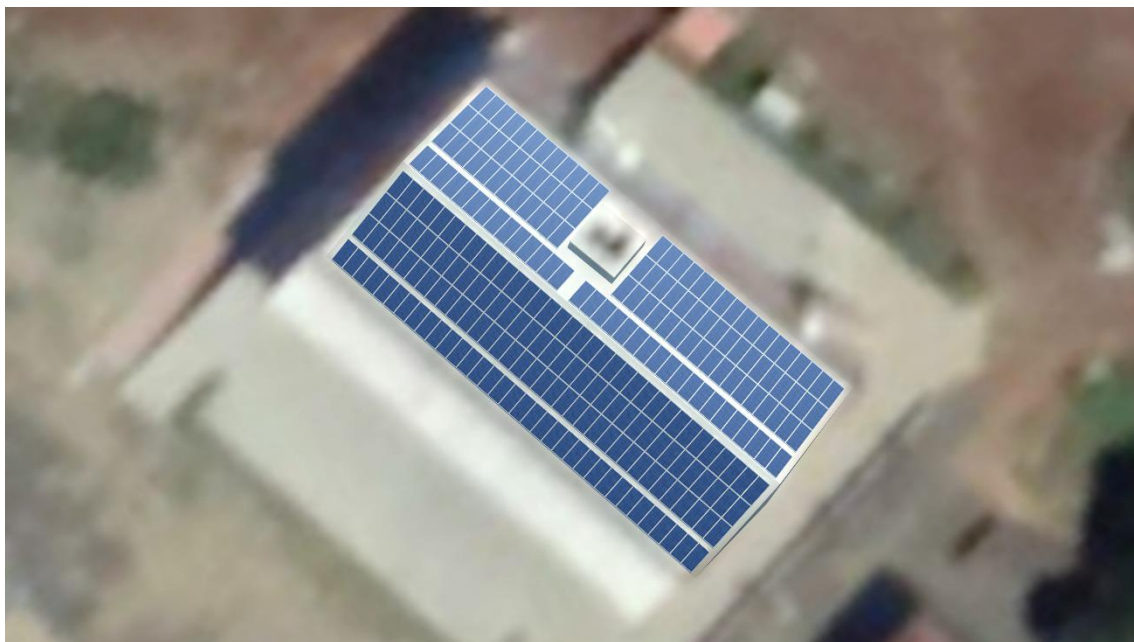
Figura 6.17 Simulação 3D do cliente 2 com 256 módulos
