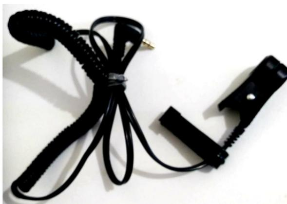
Figura 8 - Sensor óptico para captar batimentos cardíacos, usado na área desportiva e médica.
