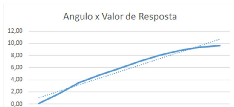
Figura 35 - Curva de resposta das intensidades atribuídas pelo sensor MPU6050 em resposta a um ângulo isolado.
