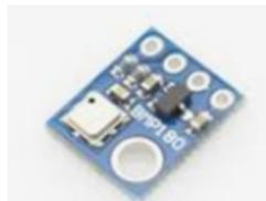
Figura 24 – Funcionamento e imagem do sensor de pressão digital BMP180 da Bosch
