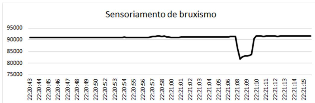
Figura 31 – Simulação da ocorrência de bruxismo captada pelo sensor desenvolvido.
