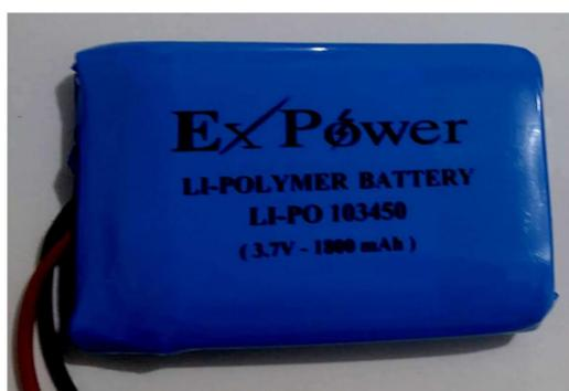
Figura 42 - Imagem da bateria lítio-polímero de 1800mAh usada para suportar o processamento do ESP com a transmissão de dados.
