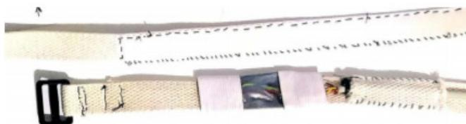
Figura 25 – Cinta torácica onde foi anexada o invólucro de ar que contém o sensor de pressão BMP180.
