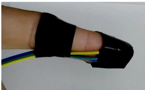
Figura 23 - Sensor de batimento cardíaco fixado na ponta do dedo.
