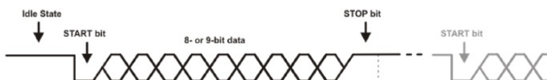
Figura 23 – Exemplo da forma de onda da comunicação UART – Fonte: (INSTRUMENTS, 2010)
